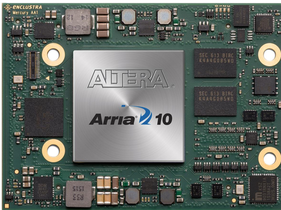
Das Mercury+ AA1 SoC-Modul von Enclustra basiert auf dem Intel Arria 10 (Bild: Enclustra GmbH)
