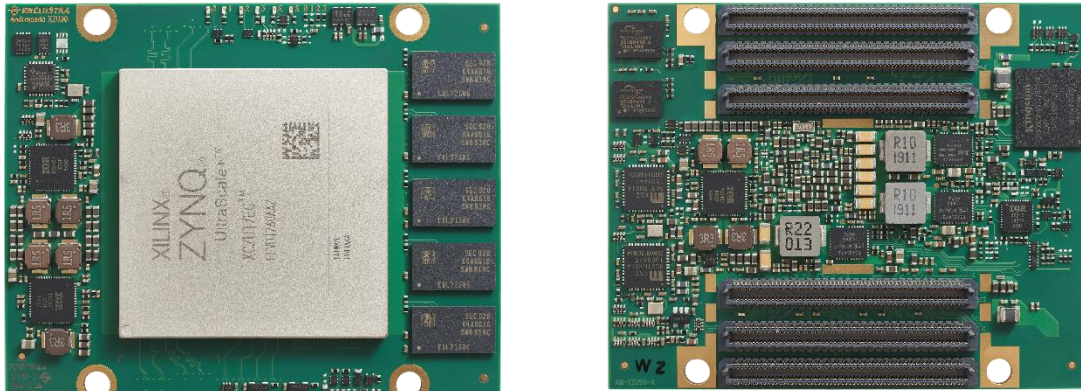
Bild 2: Andromeda XZU90 - Vorder- und Rückseite; kleiner Formfaktor: 80 × 64 mm
