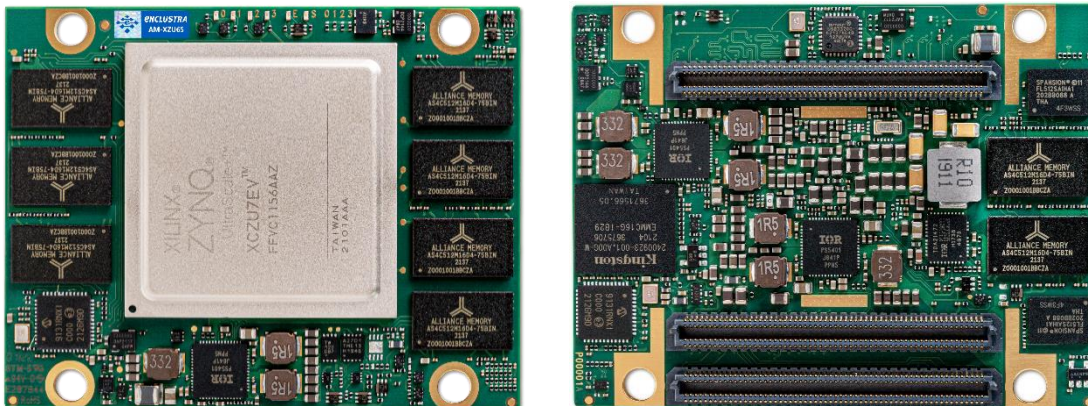
Bild 1: Andromeda XZU65 - Vorder- und Rückseite; kleiner Formfaktor: 68 × 52 mm
