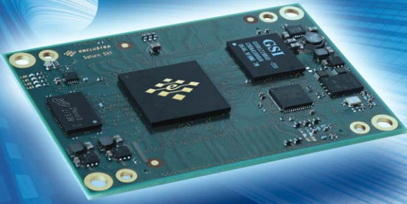
Das Saturn SX1 ist mit 54 x 76 mm kleiner als eine Kreditkarte.
